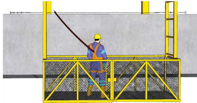
图3.1.9 悬挑式操作平台作业人员安全带系挂效果图2
